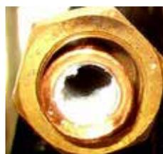
Fig. 4: Deposito di granulato nel climatizzatore rilasciato a causa di un filtro disidratatore saturo
